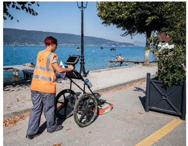
Le radar peut repérer une conduite quelle que soit sa nature (conductrice ou non). Son fonctionnement repose sur le principe de la propagation électromagnétique. L'appareil émet des ondes dans le sol qui sont réfléchies (traitement d'une onde électromagnétique autour d'une fréquence centrale donnée).
