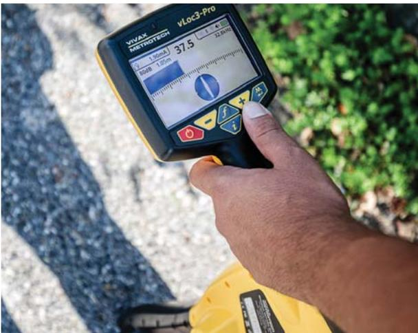
Cette méthode repose sur le principe que tout champ électromagnétique se diffusant dans un milieu plus ou moins conducteur génère un courant induit qui génère à son tour un champ électromagnétique.
